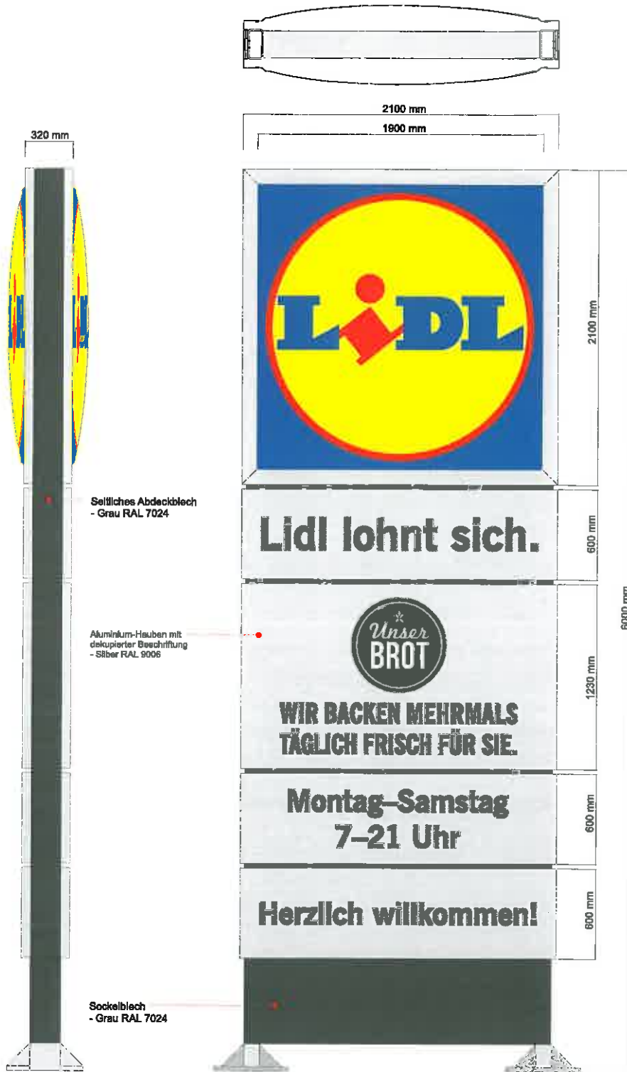
Doppelseitiger Pylon mit innenliegender Stahlkonstruktion und Aluminium-Hauben mit dekupierter Beschriftung. - Format: 2100mm x 6000mm x 320mm
